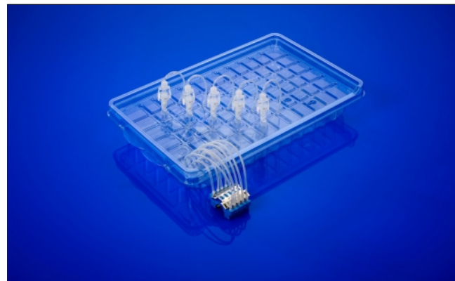
Рис. 2. Фотография биореактора Celllab: а – доккинговая станция; б – сменная платформа с пятью культуральными камерами
