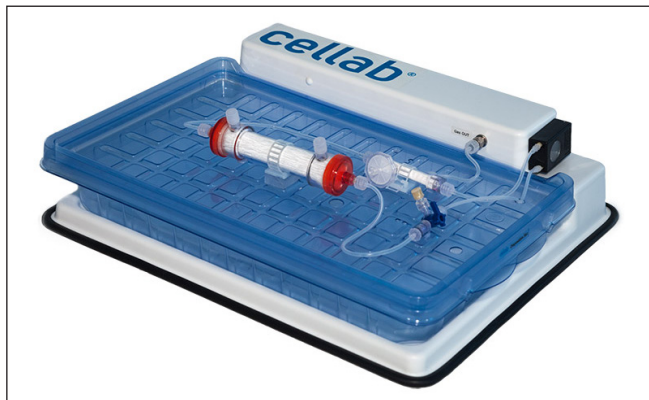
Рис. 2. Фотография биореактора Celllab: а – доккинговая станция; б – сменная платформа с пятью культуральными камерами
